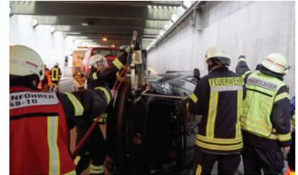
Hydraulisches Rettungsgerät wird eingesetzt, um einen Zugang in das Fahrzeug zu schaffen.
