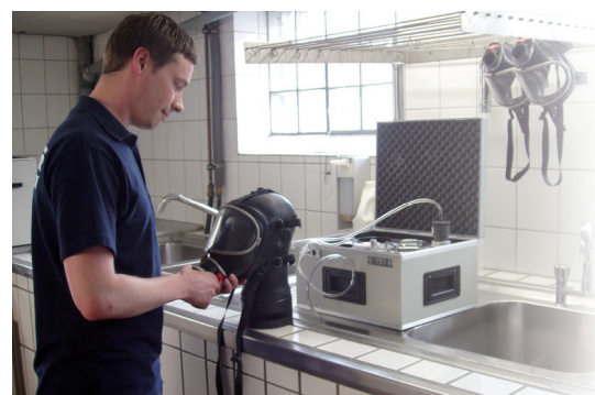
Atemschutzgerätewart Andre Schwider bei der Dichtprobe einer Atemschutzmaske
